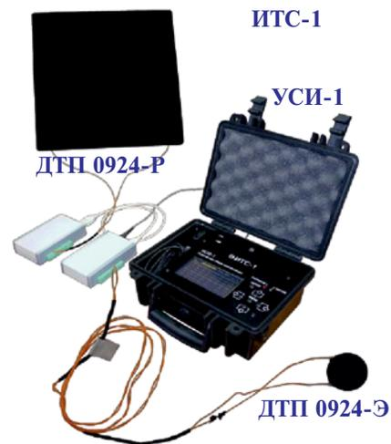
диапазон измерения напряжения. Проводили также проверку на наличие ошибок при обмене данными УСИ-1 (устройство сбора информации) и модулями КИ-16 (коммутаторы измерительные) и записи данных на SD карту. В ходе испытаний опытных образцов УСИ-1 было установлено, что полученные технические характеристики соответствуют нормам ТУ.
